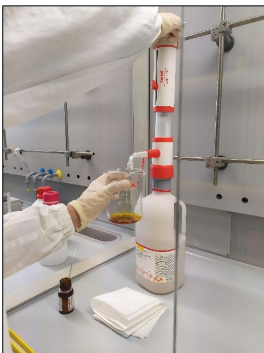
Figura 30: Aggiunta di acido solforico alla soluzione di potassio bicromato.
