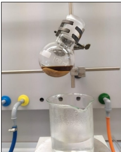
Figura 42: Decantazione della soluzione, separazione tra liquido e massa vegetale.
